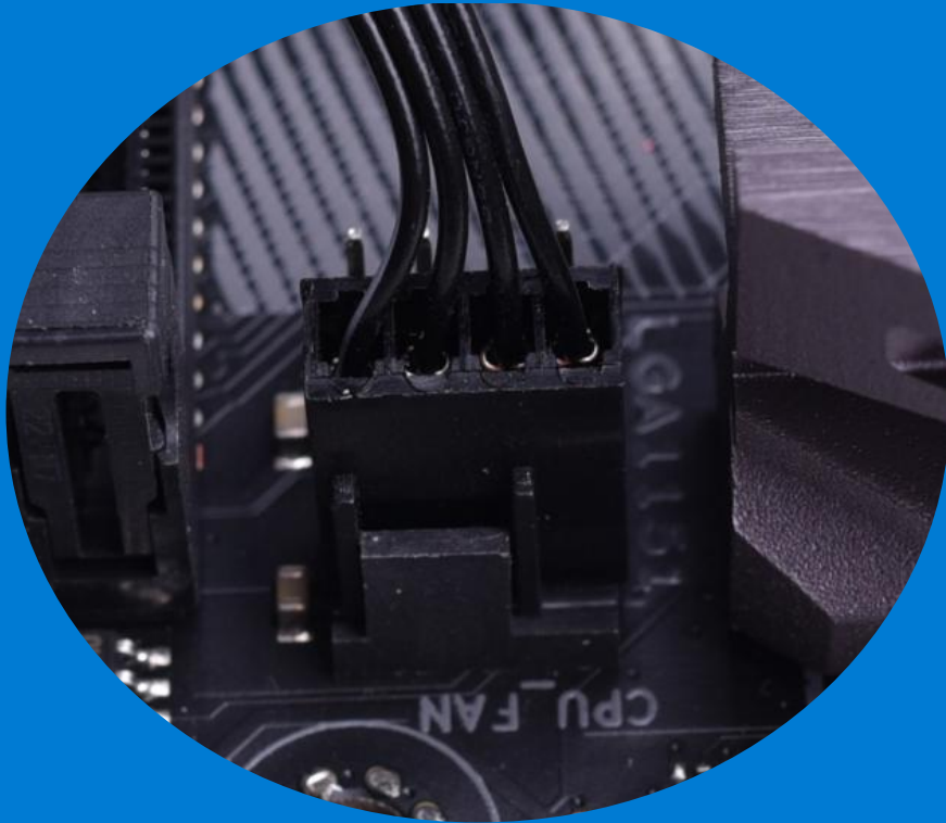
风扇供电线连接到主板的CPU_FAN或SYS_FAN或CHAFAN接口
